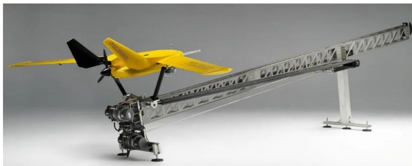
Рис. 47. БПЛА, установленный на катапульте
