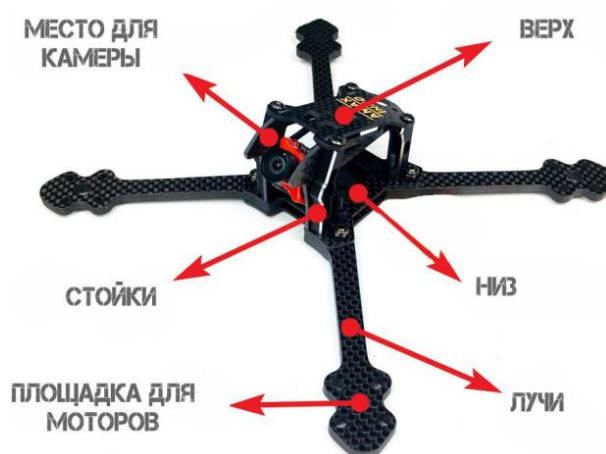
Рис. 76. Рама беспилотника с основными элементами конструкции
