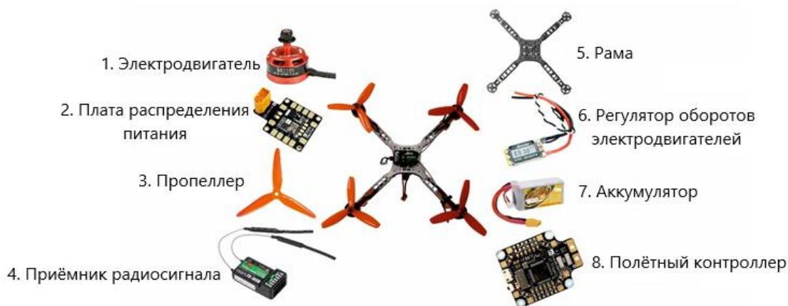
Рис. 57. Состав беспилотного летательного аппарата
