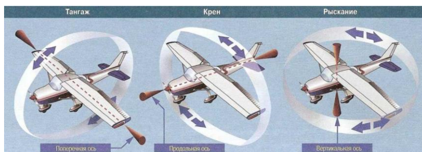
Рис. 22. Тангаж, крен, рысканье.
