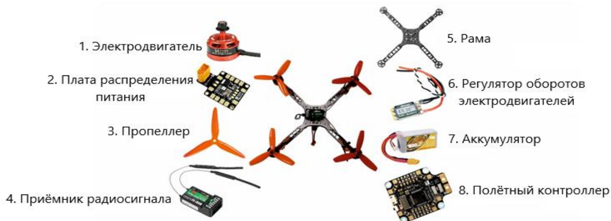
Состав основных компонентов БПЛА
