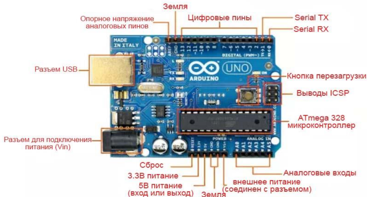
Расположение основных элементов на плате Arduino UNO
