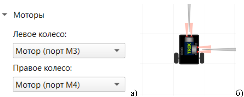
Рис. 17. Установка портов моторов (а) и расположение их на роботе (б)
