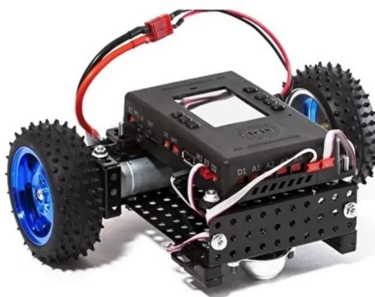
Рис.14. Внешний вид мобильного робота на базе роботизированного конструктора ТРИК
