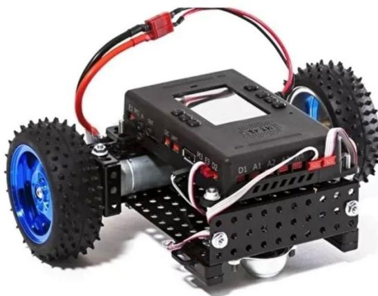
Рис.1. Внешний вид мобильного робота на базе роботизированного конструктора ТРИК
