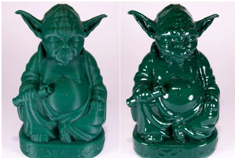
Рис. 10. Фигурка из ABS пластика после химической обработки в ацетоновой бане
