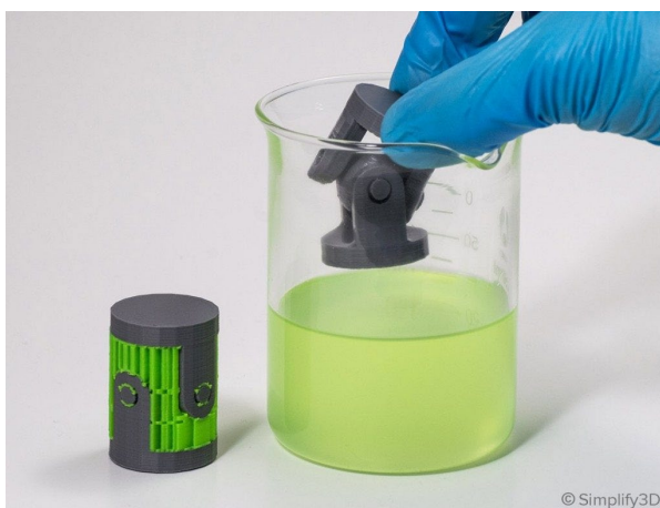
Рис. 11. Использование HIPS в качестве растворимой поддержки
