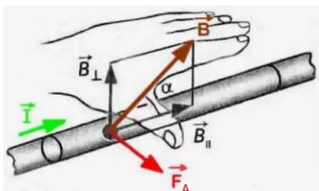
В данной задаче, если выбрать направление тока на нас, то сила Ампера будет действовать вправо, и проводник отклонится на угол  $\varphi$ .
