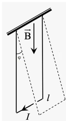
К задаче необходимо сделать рисунок, указав все силы, действующие на проводник: силу тяжести, силу натяжения нитей (их две) и силу Ампера (рис.).
