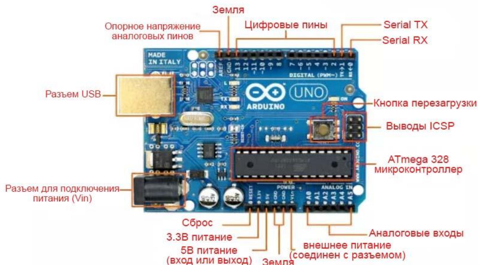
Расположение основных элементов на плате Arduino UNO
