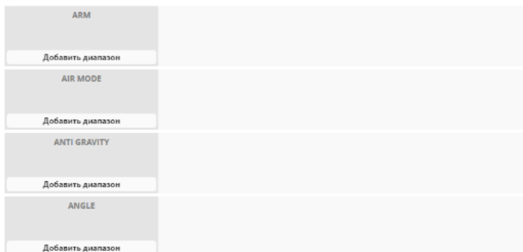
Рисунок 5. Настройка полетных режимов в программе Betaflight
