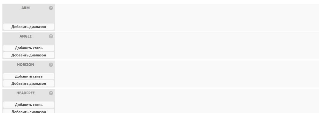
Рисунок 5. Настройка полетных режимов в программе Betaflight
