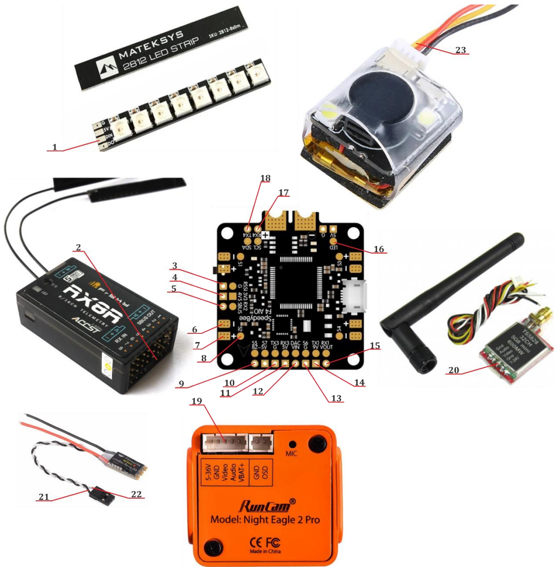
Рисунок 2. Электронные компоненты БПЛА: радиоприемник, полетный контроллер, видеопередатчик, FPV видеокамера, регулятор оборотов, пищалка, LED лента.
