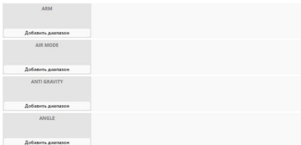
Рисунок 2. Настройка полетных режимов в программе Betaflight
