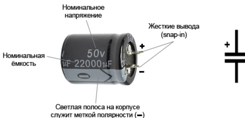
Рис. 19. Пример маркировки конденсаторов
